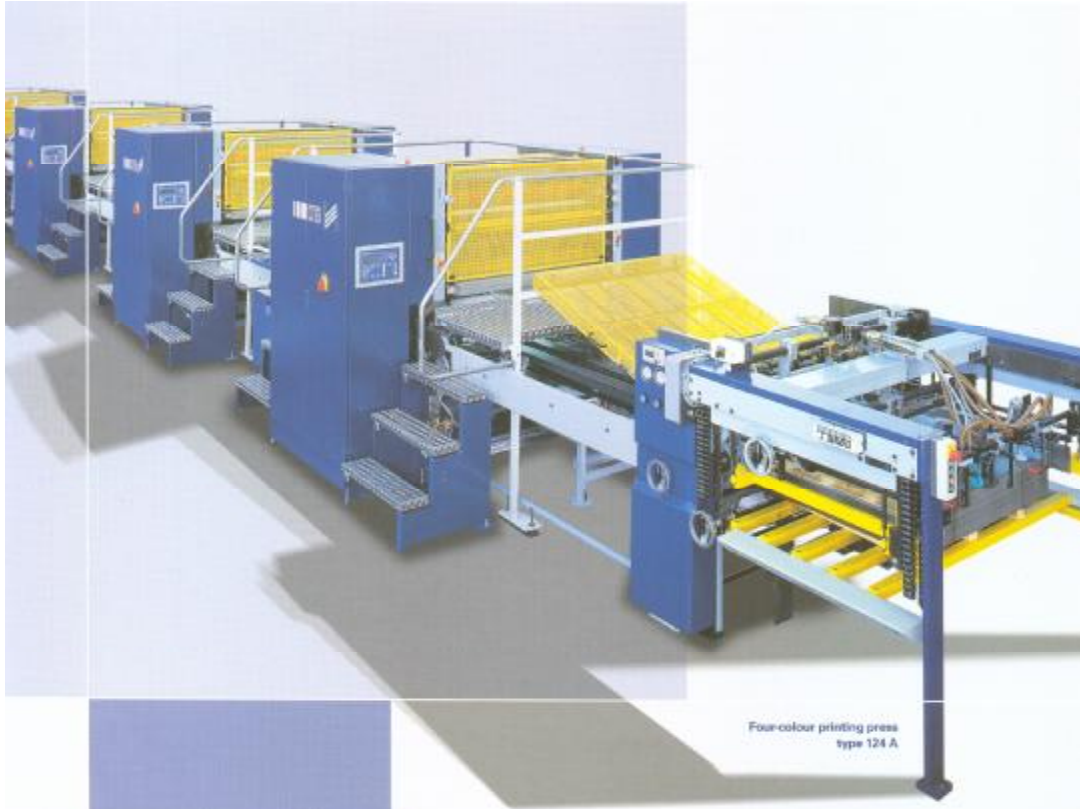
شکل ۳-۲- نمایی از ماشین چاپ افست بر روی فلز (چهار رنگ) تولید شرکت KBA(LTG MAILANDER) آلمان [ ۱۷ ]
